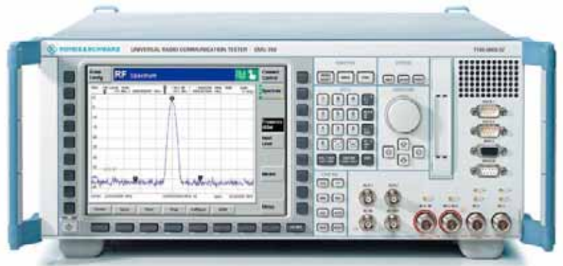
R&S®CMU200用途广泛，主要用于高速和高精度的产品制造过程。上图所示为该仪器的前面板。
